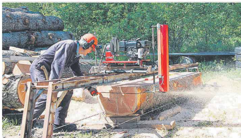
Bo Lindéns hembyggda såg är byggd av delar köpta i Kalifornien. På Almalund, Munsö använder han den just nu för att såga plankor av Douglasgran. Sågen väckte stort intresse bland "Upplands småsägare" när de var på besök. FOTO: LO BÄCKLINDER
