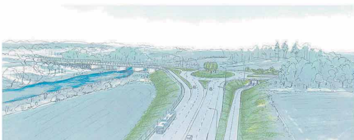
Rondellen i korsningen med Färentunavägen kommer byggas om och gång- och cykelvägen grävs ner.
