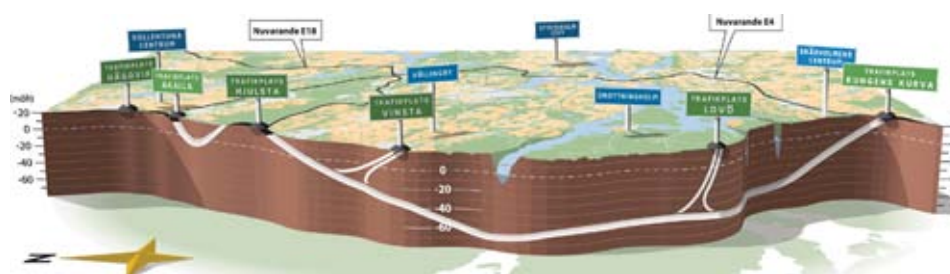
Förbifart Stockholms tunnelprofil med ramper upp till trafikplatserna Lovö och Vinsta. Profilen är inte proportionerlig. Grafik: Tomas Öhrling
