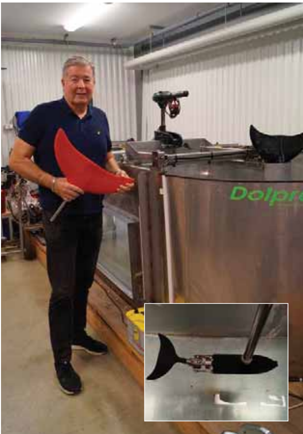
Thomas Jemt bredvid vattentanken där han testkör fenmotorn "Dolprop". Första produkten för utombordsmotorer kan vara ute på marknaden nästa år. Nu arbetar Thomas även med utvecklingen av en fenmotor till fartyg.
