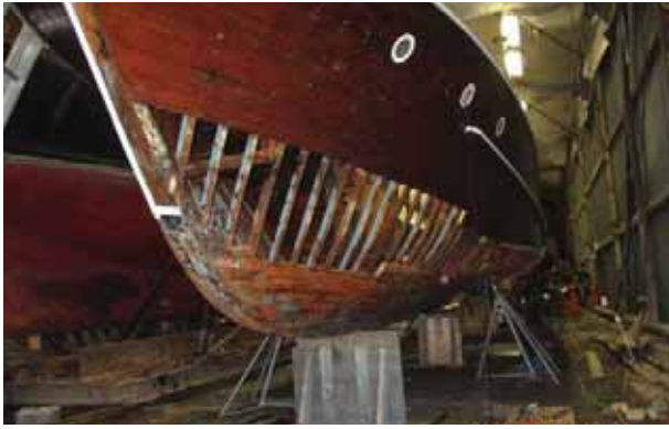
Demontering av bordläggning 2015. I stort sett det mesta måste bytas ut till nytt.
