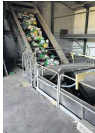
Genom optisk sortering plockas de Gröna påsarna ut och dess innehåll rötas.
